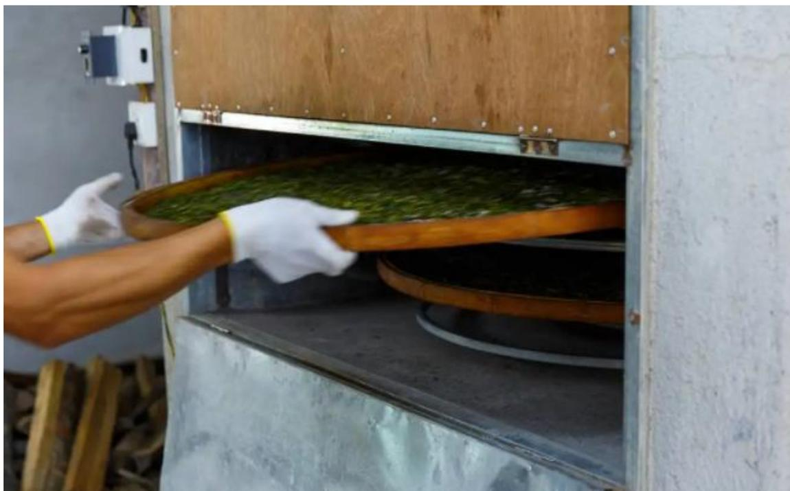
烘焙，是对揉捻后的茶叶进行最后的步骤，烘焙还包含初烘、摊凉、复烘三个子工序。初烘主要进行130~140℃的翻拌；摊凉是让茶叶凉透，使其水分分布均匀；复烘是将摊凉后的茶叶进行二次烘焙。
