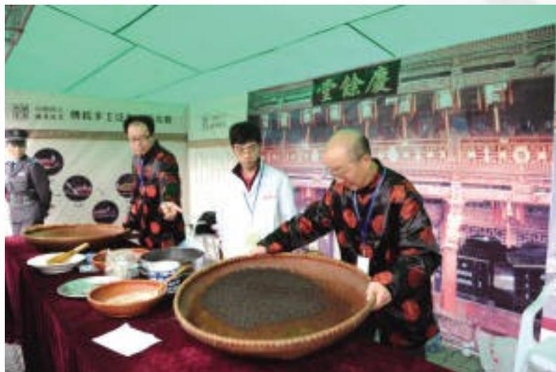
小量生产时，使用涂有桐油或油漆的光滑不漏水的圆竹匾；
