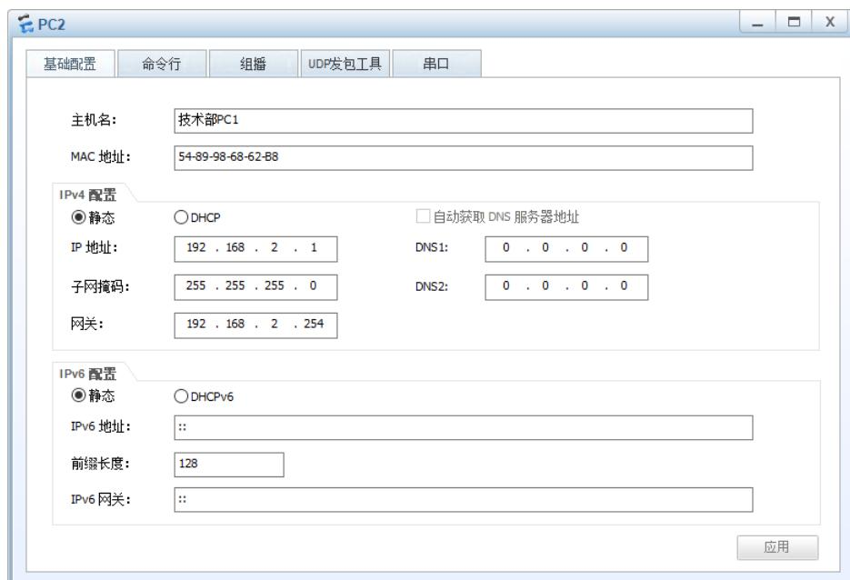
图 3 技术部-PC1 IP 配置图
