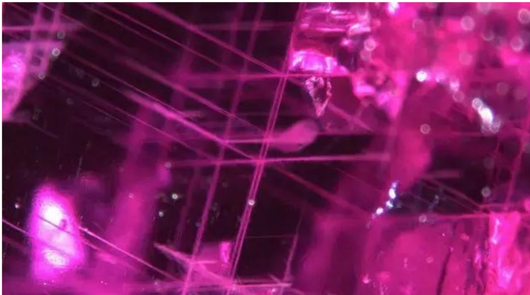
合成红宝石中典型的弧形生长纹与被拉长的气泡，与天然红宝生的长纹相比，合成红宝的弧形生长纹显得更“规则”。
