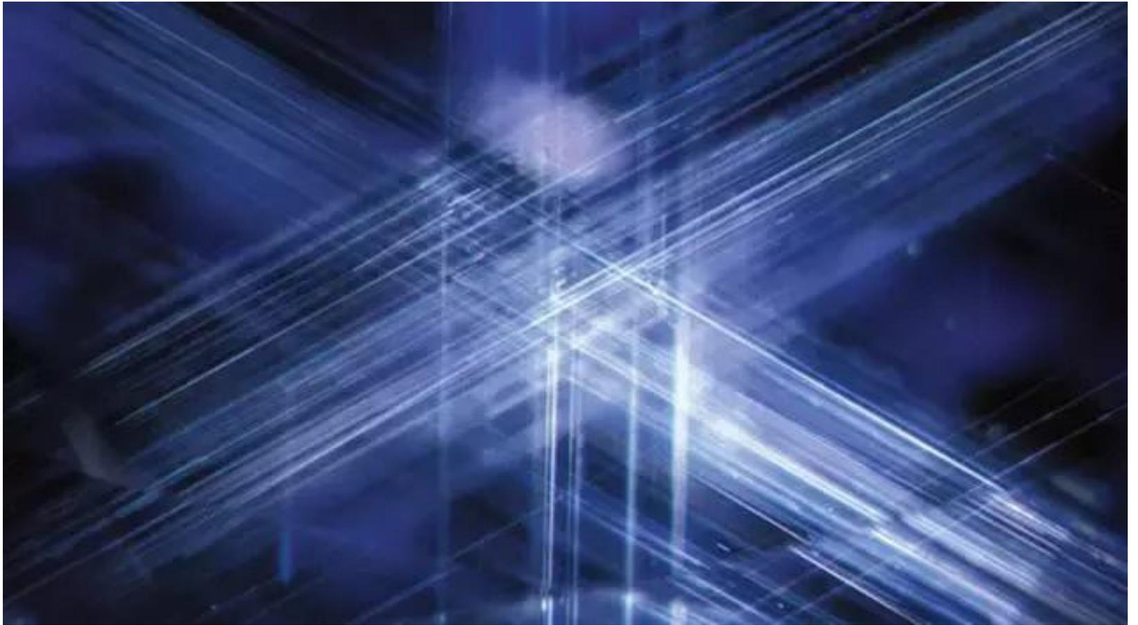
蓝宝中粒状的金红石包体受热后，其中的钛元素扩散出与蓝宝中的铁元素结合，提升了蓝宝的颜色，此颜色扩散现象是蓝宝受到热处理的证明。
