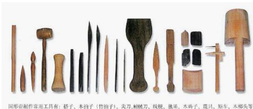
圆形壶制作常用工具有：搭子、木拍子（竹拍子）、尖刀、扁刮刀、绞梗、滚果、木鸡子、蔑具、矩车、木榔头等。
